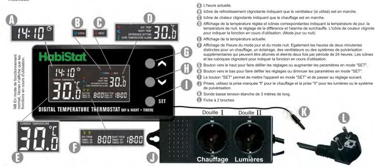
Contrôle rapide des réglages. Les réglages peuvent être vérifiés rapidement sans passer par la routine de réglage. Il suffit de les faire défiler vers le haut ou vers le bas à l'aide des flèches "Λ V". Les fonctions défileront et clignoteront pour indiquer les réglages actuels de ces fonctions qui clignotent. Vous ne pouvez pas modifier ces réglages de cette manière et l'affichage normal reprendra si vous n'y touchez pas pendant 5 secondes.
