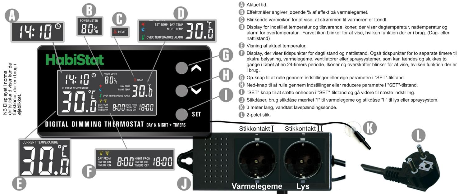
**INDSTILLINGER**- Tryk på knappen "SET", og hold den nede i 3 sekunder. Dette sætter enheden i "SET"-tilstand. Brug knapperne "**A V**" til at ændre parametre (hold knappen nede for hurtig ændring), og tryk derefter på "SET" for at gemme og gå videre til den næste indstilling. Rækkefølgen er vist nedenfor. Fremhævede elementer indikerer blinkende display.
